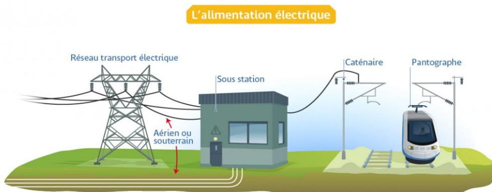
Fig.19. Sous-stations de traction
